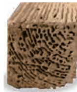
ヤマトシロアリなどによる食害木材。年輪を避けて柔らかい部分を浸食。
