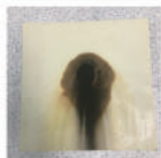
図 5.54 燃焼後のダンボール（燃焼 45度）の様子（左）
