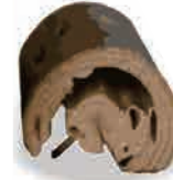
アメリカカンザイシロアリによる食害木材。年輪を越えて大きな坑道を形成して浸食。
